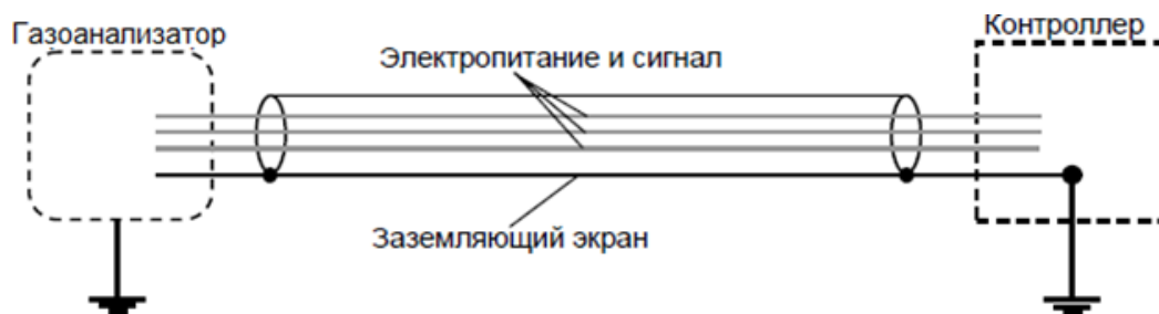
Рисунок 40 – Заземление экранированного кабеля
